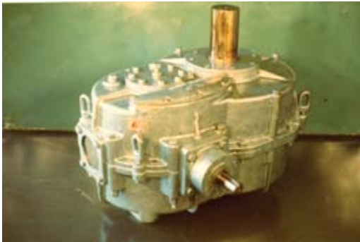
Redutor de velocidade com embreagem pneumática e dois eixos de saída para fábrica de pás
