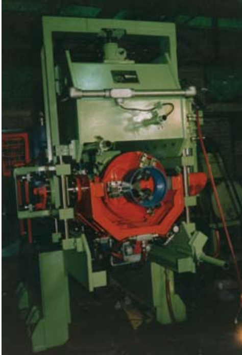
Robô para a colocação de protetores de rosca em tubos sem costura, fabricados para Siderca do grupo Techint
